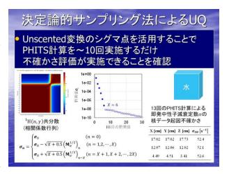
面積の共分散行列に起因した $\alpha$ 不確かさ評価を試みた。結果として、共分散行列の主成分に対応する特異ベクトル方向に摂動させた 13 セットの摂動後  $^{1}$ H 核データファイルを用いた 13 回のみの PHITS 計算結果から推定された $\alpha$ 不確かさ評価結果が、別途評価された参照値(決定論的手法に基づいた一次摂動論による $\alpha$ 不確かさ評価結果)とほぼ同じ結果となることが確認できた。入力パラメータ次元数の大きな核データ共分散行列の場合についても、次元削減が可能であれば、核データ起因の不確かさ評価手法として決定論的サンプリング法が有効であることが分かった。
