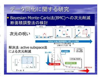
となる。今年度研究では Godiva 臨界実験体系を対象として、U235 共分散行列に基づきランダムサンプリング法で摂動させた核データを仮想真値とした数値実験(双子実験)を実施し、BMC 法による核データ調整の改善方法について検討した。具体的には、評価済み核データの共分散行列や感度係数行列(核データ微小変化に対する炉心特性値の変化)に対して active subspace(有効部分空間)を推定し、その部分空間内で次元を削減した上で BMC 法を適用することにより、少ない BMC サンプル数でも精度良く核データ調整が可能となる見込みを得ることができた。
