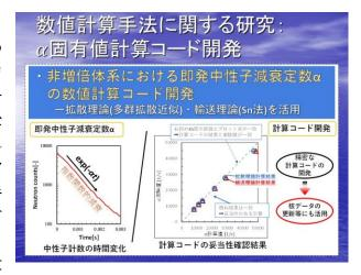
近似と形状バックリング近似に基づくエネルギー多群の $\alpha$ 固有値計算コード、および②一点炉加速法と  $S_N$ 輸送計算法に基づく $\alpha$ 固有値計算コードの 2 つを試作した。過去に実施された水槽を対象としたパルス中性子実験で測定された $\alpha$ 実験値と、開発した計算コードによって得られた $\alpha$ 計算値がほぼ等しいことを確認することで、開発した計算コードの妥当性確認(Validation)を実施することができた。
