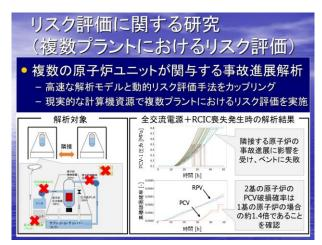
ロ(CMMC) 法に注目し、①高速に事故進展を予測可能な簡易解析コードと②CMMC 法を組み合わせることで、マルチユニットリスク評価に対する CMMC 法の適用性について検討を実施した。全交流電源+注水機能喪失時における原子炉事故進展を高速に解析する簡易コードを作成した上で、複数の原子炉ユニットを対象として、それぞれの原子炉状態に応じてベント失敗確率を変化させて、提案手法によりユニット間の相互作用を考慮した形で事故進展に伴う各原子炉の RPV や PCV 破損確率の時間変化が推定できることを確認し、現実的な計算コストでマルチユニットのリスク評価を実施するための方法論を構築することができた。
