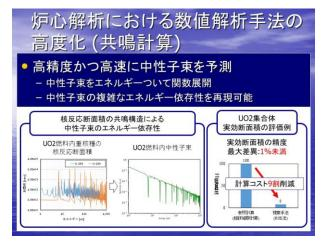
て、Resonance calculation using energy Spectrum Expansion (RSE) 法を開発した。共鳴干渉効果が現れる燃料集合体体系など、実際の原子炉炉心解析における典型的な計算条件に対して提案手法を適用し、超詳細群減速計算によって得られた実効断面積の参照解とRSE法による推定結果の差異が小さいことを確認し、本研究で開発したRSE法によって計算コストを大幅に低減できることも確認できた。
