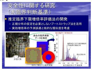
の効果を考慮した「ブートストラップ法」に基づく推定臨界下限増倍率の評価手法を新たに考案した。京都大学臨界集合体実験装置(KUCA)における実際の未臨界炉心を対象として、提案手法により未臨界判定ができることを確認することで、提案手法の妥当性を確認した。また、燃料デブリ模擬体系に対して提案手法を適用することで、減速材対燃料体積比や減速材の種類(水・コンクリート)が推定臨界下限増倍率の評価結果に与える影響についても調査した。
